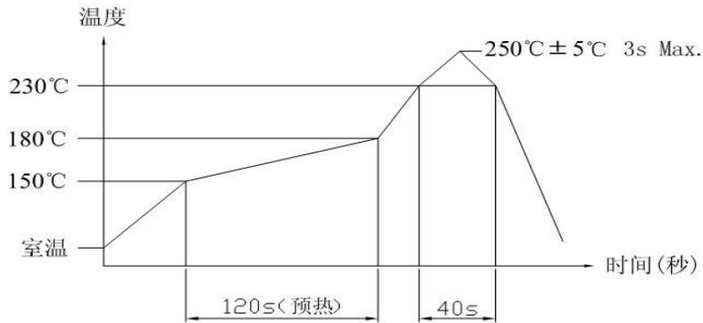
注意：上述条件温度为印刷电路板的零部件贴装面上的温度
