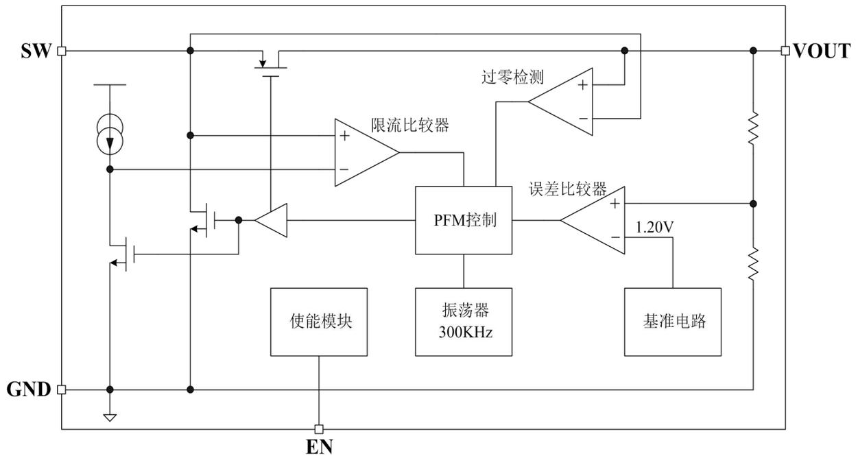
图 2: HL7800A 的内部电路方框图
